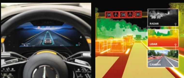
Links: Der Drive Pilot von Mercedes ermöglicht autonomes Fahren auf Level 3 ab diesem Frühjahr bis zu einem Tempo von 95 km/h.
