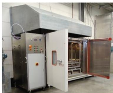
FERCHAU Automotive erweitert seine Klimakammer in der Niederlassung in Wolfsburg um eine Druckschwell- und eine Temperaturwechseleinheit. Dafür werden modulare Anbauten an die Klimakammer angeschlossen. Kühlkreislaufbauteile eines Autos, etwa Schläuche, Wärmetauscher, Batteriegehäuse und Aus-
