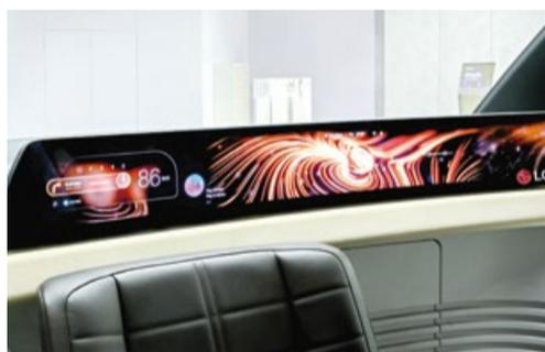
**Das bislang größte Automobildisplay stammt von der Firma LG und hat eine Bildschirmdiagonale von 1,45 Metern.**
