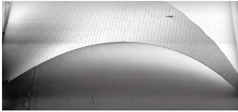
Flexible polykristalline Diamantnanomembran Aufnahme mit einem Rasterelektronenmikroskop (77-fache Vergrößerung)
